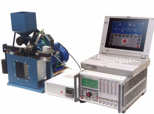
Rys. 5. Widok stanowiska badawczego testera tribologicznego T-07
