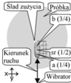
Rys. 1. Usytuowanie próbki badawczej i miejsca pomiaru AFM na próbce
