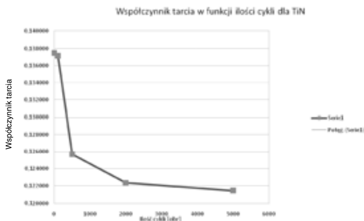
Rys. 8. Przykładowy przebieg współczynnika tarcia w funkcji liczby cykli dla płytki tytanowej
