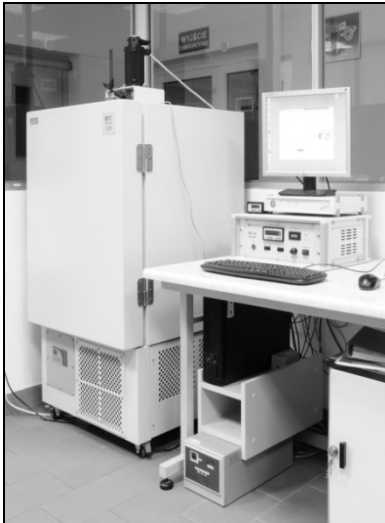
Rys. 1. Stanowisko badawcze T-25 do badań w niskich temperaturach: a) widok, b) głowica badawcza
