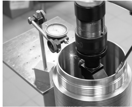
Rys. 2. Ogólny widok stanowiska do laserowego nanoszenia mikrozasobników (a) oraz laserowa obróbka tulei cylindrowej (b)
