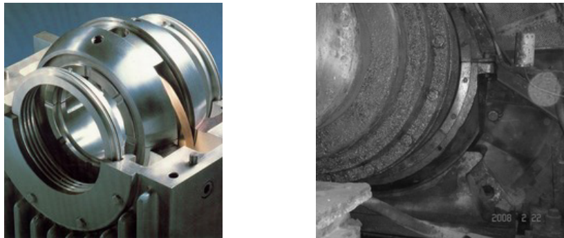
Rys. 3. Typowe łożyska ślizgowe podparte na czaszy kulistej
