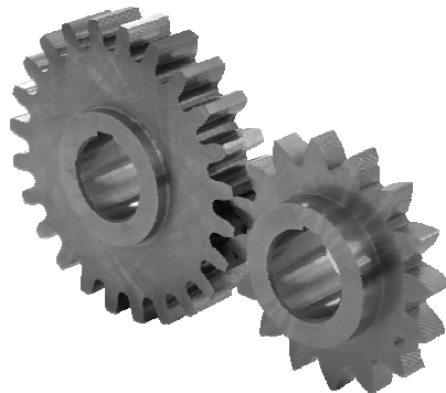
Rys. 2. Zdjęcie pary kół testowych FZG typu A10 do badania zacierania
