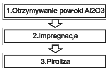
Rys. 3. Schemat blokowy technologii otrzymywania nanorurek węglowych typu \alpha -CNT Fig. 3. A block diagram of a production technology of the carbon nanotubes of the \alpha -CNT type
