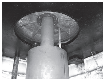
Rys. 5. Zamocowanie płyty do ramy fundamentowej
