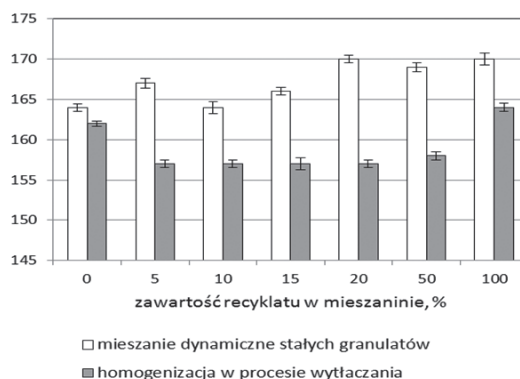
Rys. 3. Zależność współczynnika rozszerzenia strugi ( \beta ) od zawartości recyklatu w mieszaninie, przy obciążeniu tłoka plastometru 2,16 kg – 1,97 kPa
