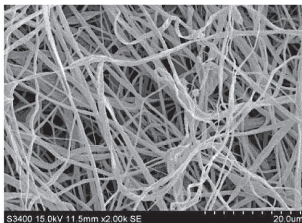
Fot. 2. Zdjęcie SEM powierzchni nanowłókien acetylocelulozy
