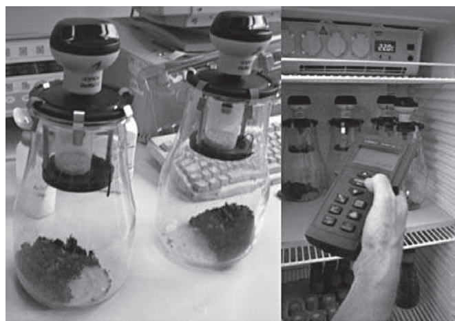
Fot. 2. Naczynia OxiTop zawierające próbki, absorbent oraz sensory podciśnienia. Sczytywanie danych przy użyciu kontrolera
