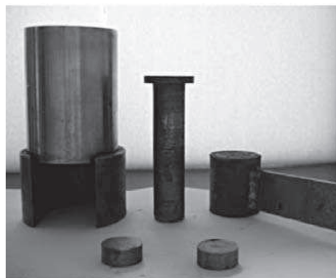
Fot. 2. Prasa matrycowa oraz forma do prasowania
