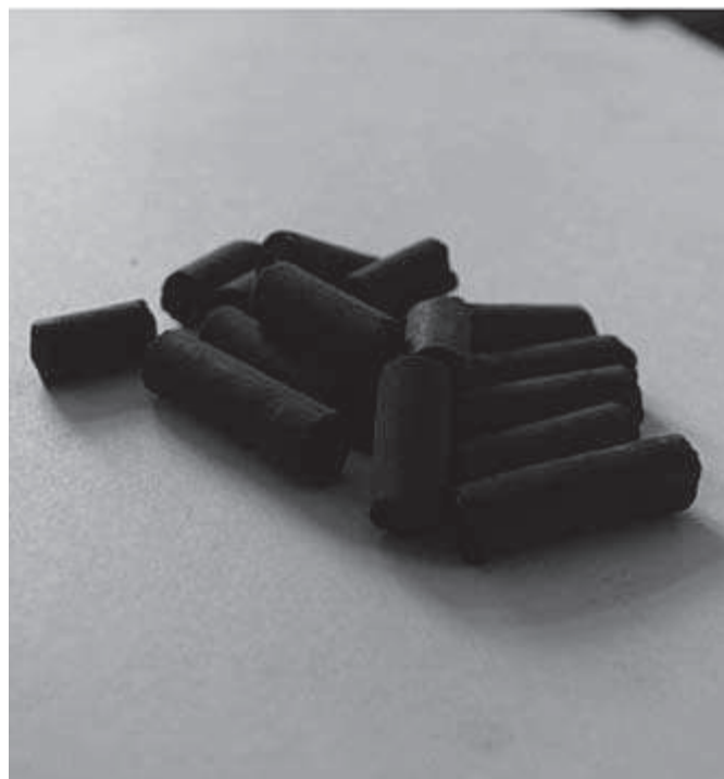
Rys. 6. Pelety z lignocelulozy pohydrolitycznej o zawartości wilgoci 20,6% m/m
