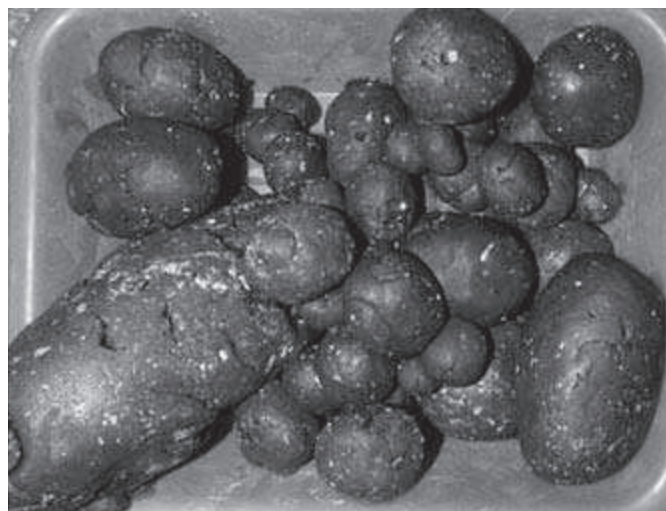
Rys. 4. Granulat uzyskany z mułu węglowego KWK „Piast” bez dodatku czynnika wiążącego
