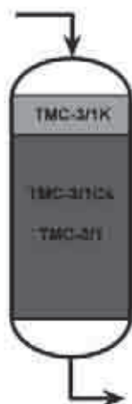
Rys. 7. Złoże katalizatora TMC-3/I w reaktorze przemysłowym
