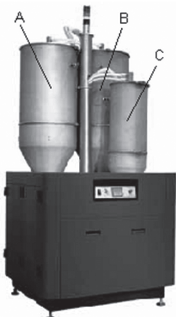
Rys. 3. Wygląd ogólny stacji mieszająco-dozującej [Schmitt, 2008]: A – zasobnik z tworzywem pierwotnym, B – zasobnik z tworzywem wtórnym, C – mieszanina tworzywa pierwotnego i wtórnego
