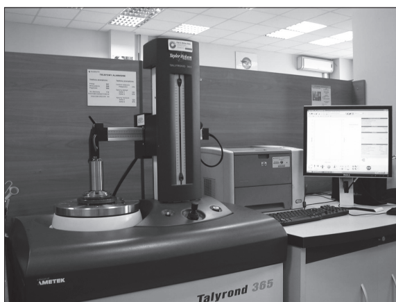
Rys. 2. Urządzenie pomiarowe Talyrond 365 firmy Taylor Hobson
