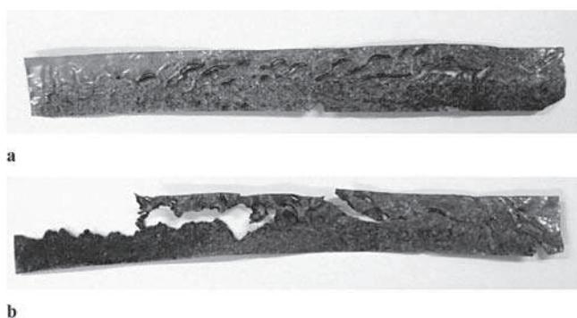
Rys. 2. Płytki kontrolne po detonacji w stożku ściętym 30-45 mm mieszanin saletrzak/pył aluminiowy: a – 97/3, b – 94/6
