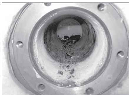
Rys. 5. Karbonizat otrzymany po pirolizie mieszaniny tworzyw sztucznych (PE, PP, PET)
