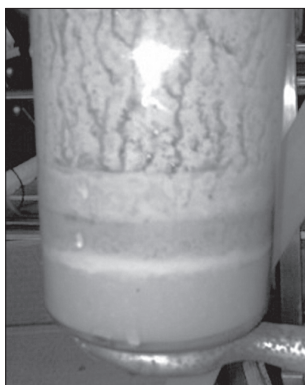
Rys. 6. Olej pirolityczny otrzymany z pirolizy mieszaniny tworzyw sztucznych (PE, PP, PET)
