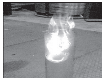
Rys. 3. Próba palności gazów pirolitycznych otrzymanych z pirolizy mieszaniny tworzyw sztucznych (PE, PP, PET)
