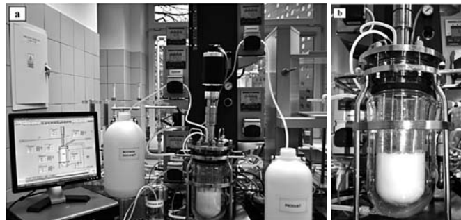
Rys. 1. Zdjęcie instalacji doświadczalnej do badania procesu ciągłego wytrącania i krystalizacji struwitu: a) widok ogólny, b) krystalizator z wewnętrzną cyrkulacją zawiesiny typu DT MSMR
