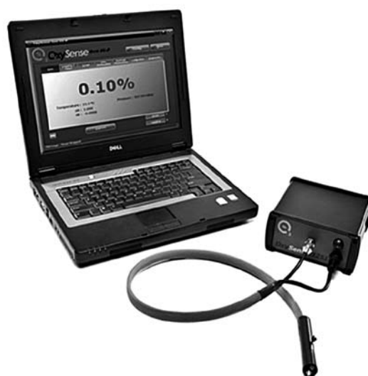
Rys. 1. Przykładowy system do pomiaru ilości tlenu z wykorzystaniem zjawiska fluorescencji [2]
