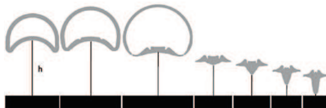
Rys. 3. Proces formowania się strumienia kumulacyjnego z ŁKL prasowanego – krok czasowy 3,00 \cdot 10^{-3} , ms
