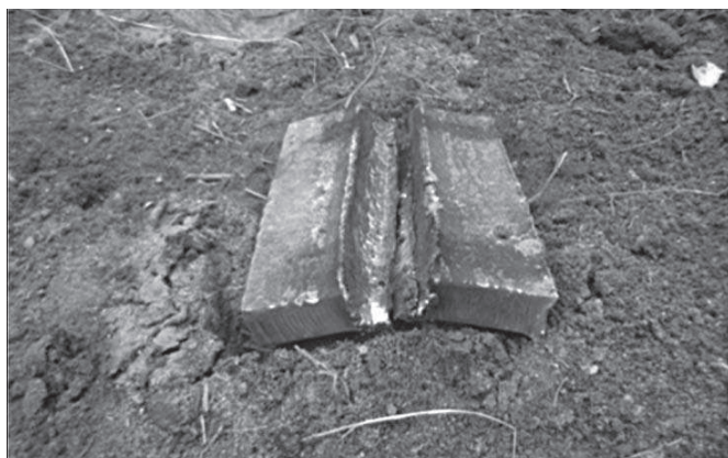
Rys. 6. Efekt działania strumienia kumulacyjnego
