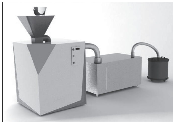
Rys. 4. Stanowisko do rozdrabniania nasion olejnych, wykonane w środowisku SolidWorks
