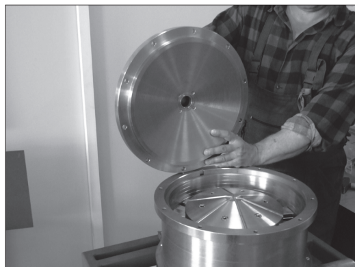
Rys. 3. Widok prototypu rozdrabniacza precyzyjnego RPW-17TN, będącego efektem transformacji rozdrabniacza laboratoryjnego RPW-11TN
