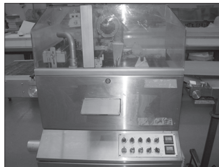
Rys. 5. Mechaniczna oblewarka z systemem cyrkulacyjnym grzania wodą
