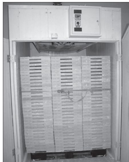
Rys. 2. Suszarnia wypełniona skrzynkami z mąką formierską
