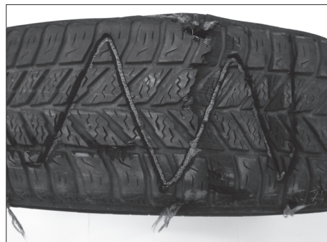
Rys. 1. Widok opony po oddziaływaniu strumienia wody o wysokim ciśnieniu
