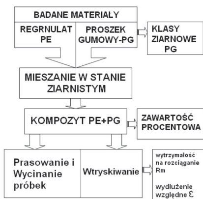
Rys. 1. Schemat blokowy przygotowania próbek do badań (typ I i II) [4]
