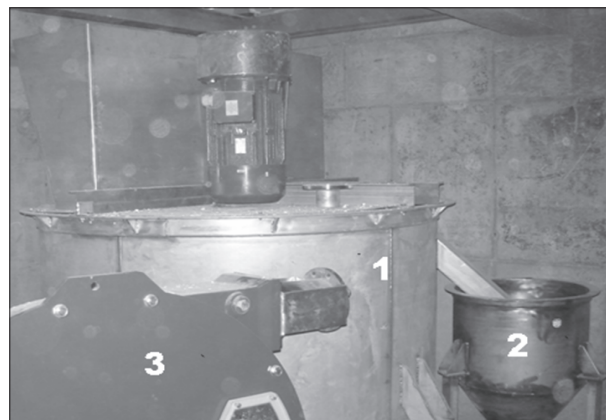
Rys. 6. Fragment linii recykulacji odpadów płyt włókno-cementowych: 1 – rozwłóknierz, 2 – kadka, 3 – pompa SPX 100
