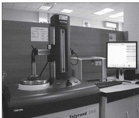
Rys. 2. Urządzenie pomiarowe Talyrand 365 firmy Taylor Hobson
