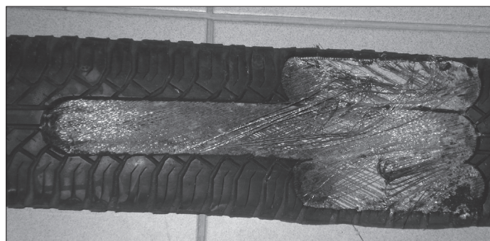
Rys. 1. Opona po zastosowaniu metody Water-Jet
