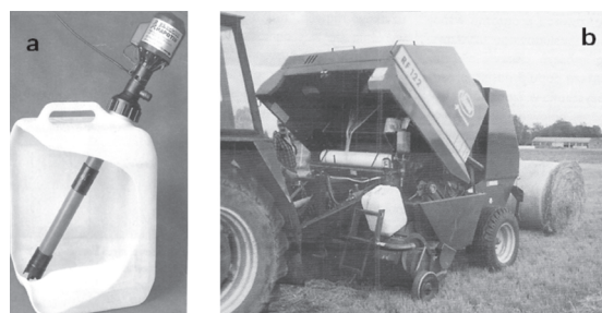
Rys. 4. Aplikator ciśnieniowy Junkkari ; a) widok ogólny, b) aplikator zamontowany na prasie związającej [2]
