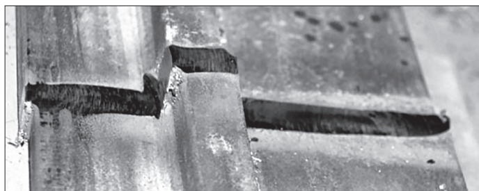
Rys. 3. Zgrzeina po frezowaniu
