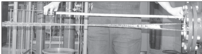
Rys. 4. Zdjęcie przedstawiające obrót o 180° strugi wodnej wypływającej ze zbiornika przez szczelinę nr 2 (Tab. 1) przy wartości naciśnienia wewnątrz wynoszącej 1,28 bara
