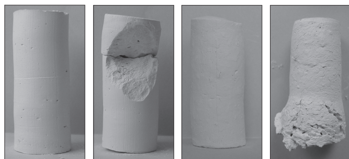
Rys. 2. Próbki wykonane z kaolinu KSP suszone mikrofalowo mocą 180 W (1 i 2 od lewej) i mikrofalowo-próżniowo mocą 300 W (3 i 4 od lewej)
