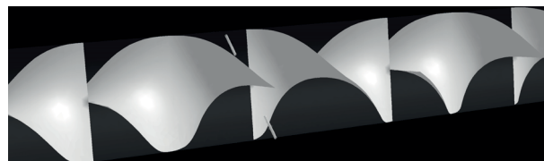
Rys. 1. Mieszalnik statyczny typu Kenics: widoczne elementy statyczne i dwie rurki dozujące substrat B
