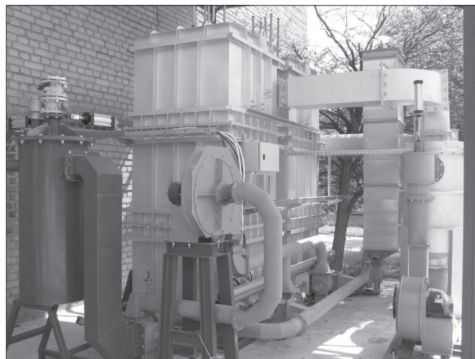
Rys. 1. Instalacja demonstracyjna reaktora rewersyjnego do niekatalitycznego spalania metanu
