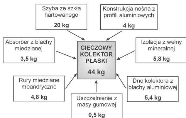
Rys. 1. Bilans masowy płaskiego, cieczeniowego kolektora słonecznego o mocy cieplnej znamionowej 1,74 kW i wymiarach 2037×1134×80 mm
