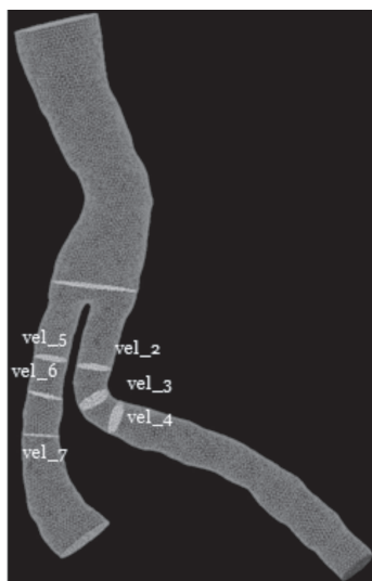
Rys. 3. Badana geometria wraz z płaszczyznami do odczytu prędkości ciśnienia
