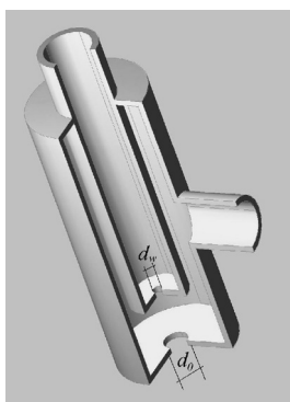
Rys. 1. Konstrukcja badanej dyszy pneumatycznej
