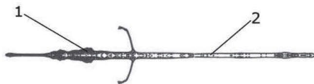
Rys. 2. Obraz zbitki (1) i strumienia kumulacyjnego (2)
