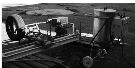
Rys. 4. Stanowisko badawcze z obracającą się oponą
