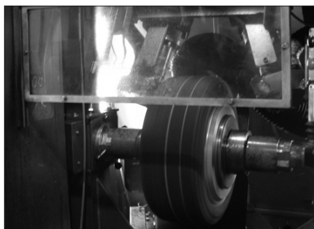
Rys. 1. Mechaniczne szorstkowanie opony
