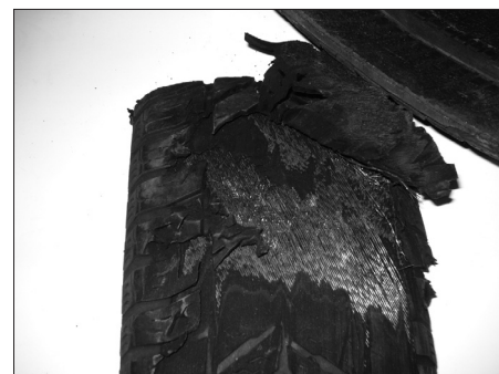
Rys. 6. Oddziaływanie strumienia wody na rozplaszczoną oponę oraz efekt tego oddziaływania
