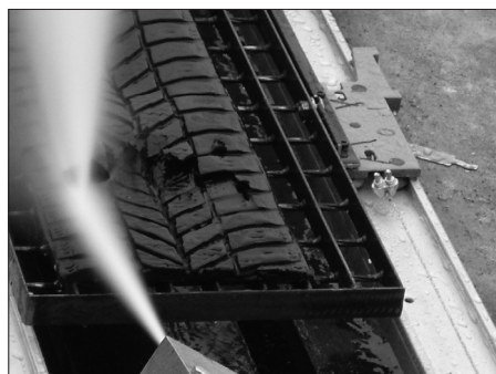
Rys. 6. Oddziaływanie strumienia wody na rozplaszczoną oponę oraz efekt tego oddziaływania
