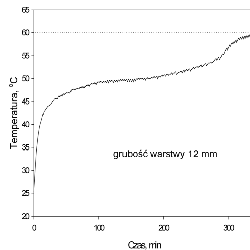
Rys. 4. Przebieg zmian temperatury materiału w czasie suszenia
