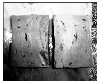
Rys. 13. Struktura wewnętrzna próbki kaolinu w 30 minucie, suszonej przy 20% intensywności promieniowania
