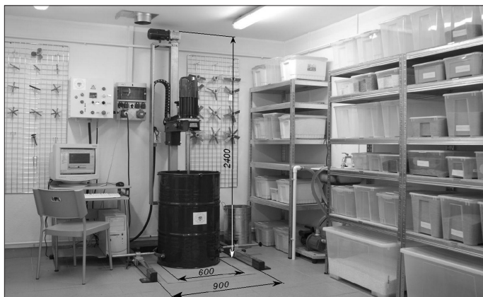
Rys. 2. Widok stanowiska do badania procesu mieszania w skali technicznej
