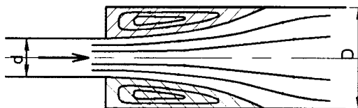
Rys. 1. Schemat przepływu za skokowym (nagłym) rozszerzeniem rury
