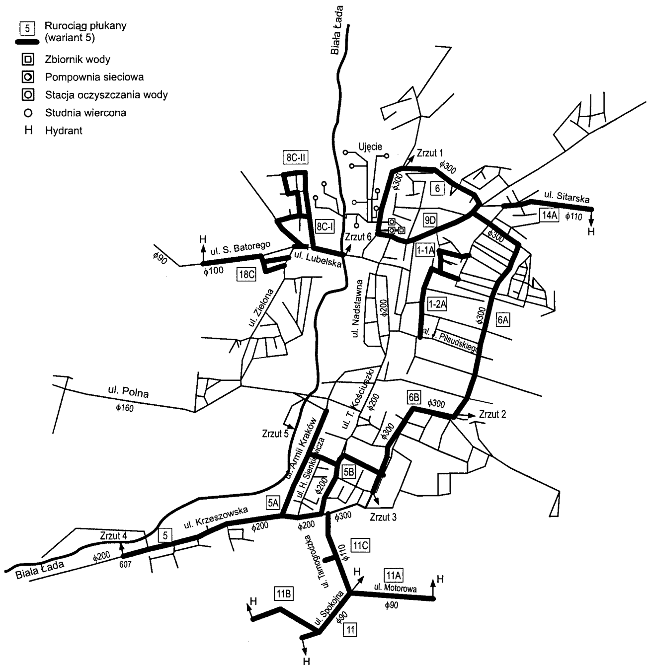
Rys. 1. Schemat strukturalny układu wodociągowego w Biłgoraju
