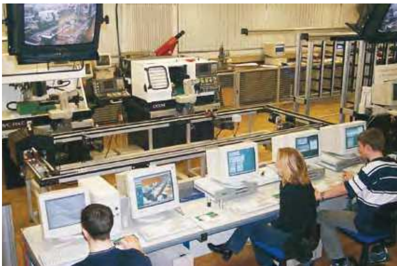
Rys. 3. Laboratorium CAD/CAM/CNC w College'u Mac-kworth w Wielkiej Brytanii [2]. Zestaw maszyn składa się kolejno od lewej strony z: frezarki, tokarki, dwóch robotów, systemu transportu palet i magazynu wysokiego składowania.
