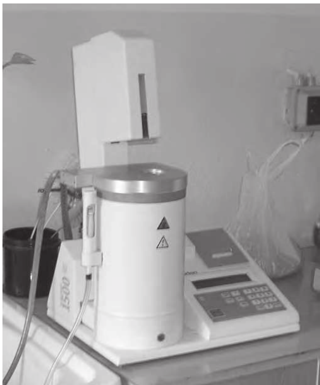
Rys. 1. Zdjęcie przedstawiające urządzenie do oznaczania liczby opadania PERTEN 1500, [Foto, J. Rut, K. Szwedziak].
