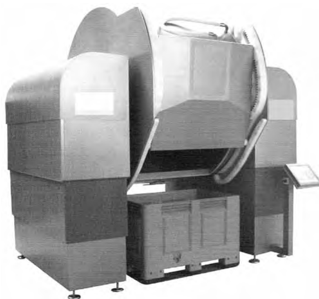
Rys. 9. Widok masownicy mieszadłowej z poziomym, obrotowo-uchylnym bębniem.
