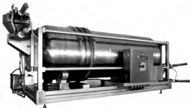
Rys. 7. Widok masownicy bębnowej o działaniu ciągłym.
