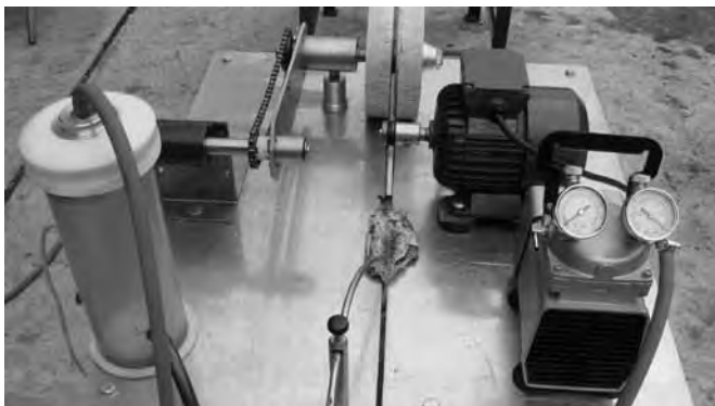
Rys. 5. Model do bezpośredniego usuwania nerki metodą wysysania. Na pierwszym planie widoczne elementy modułu wysysającego: pompa próżniowa, zbiornik buforowy i króciec ssący.
